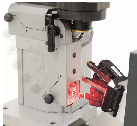
Swivelling center height camera »inScreen«
